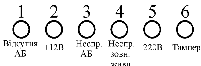
Рисунок 5.4 – Розширена індикація несправностей живлення
