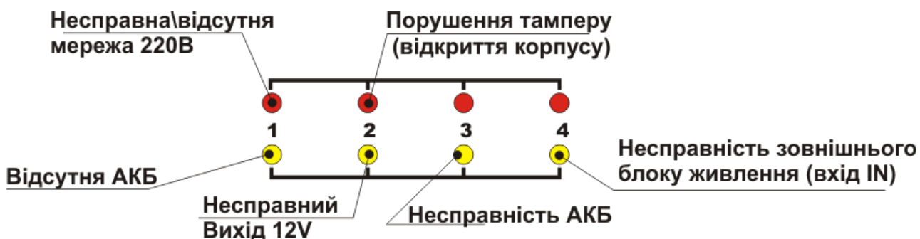
Рисунок 5.1 – Розширена індикація несправностей живлення для Тірас-4П
