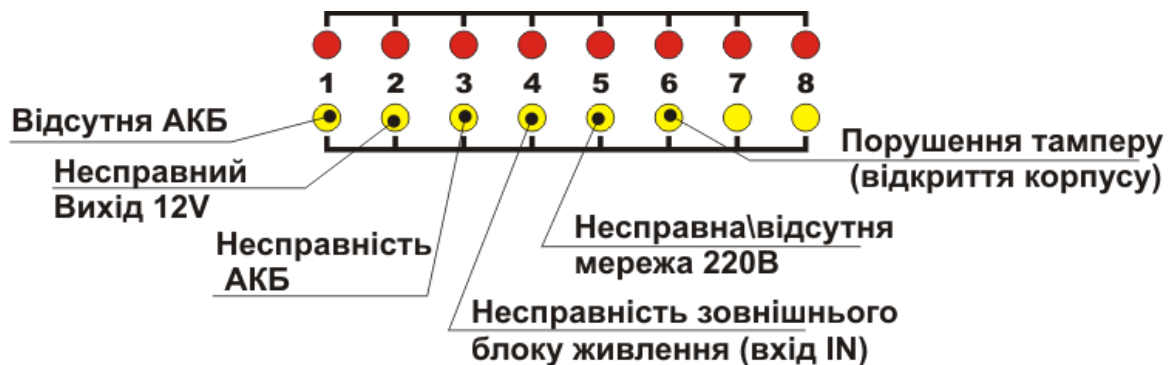
Рисунок 5.2 – Розширена індикація несправностей живлення для Тірас-8П
