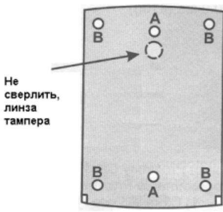
Проложите кабель от контроллера и подсоедините нужные жилы к жилам кабеля считывателя AY-Q54 (распайка приведена ниже). Прикрутите заднюю крышку к стене и прикрепите переднюю крышку поставляемым в комплекте специальным винтом. Также в комплекте имеется специальный ключ.
