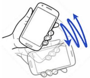
Рис. 2. Активация U-Prox ID с помощью встроенного акселерометра
