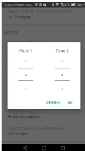
**"Рабочие часы" (Дневное время)** – настройка автоматической смены ночного режима на дневной. В указанном временном интервале прибор будет в дневном режиме, вне интервала – в ночном. Если режим отключен – перевод в ночной и дневной режим возможен только вручную, при предъявлении идентификатора с соответствующей функцией.
