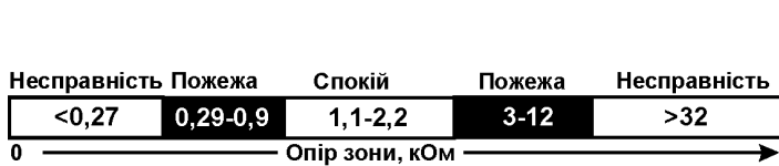
Рисунок 4.3 – Границі режимів зон ППКП для сповіщувачів з нормально замкнутим контактом
